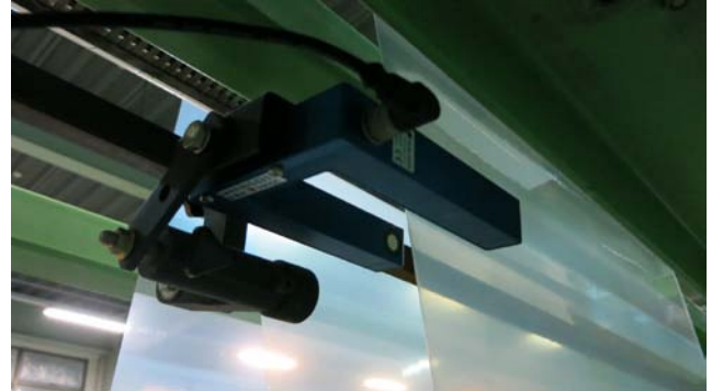
Ultrasonik Sensör DU-2 şeffaf film üzerinde kullanılmaktadır.
